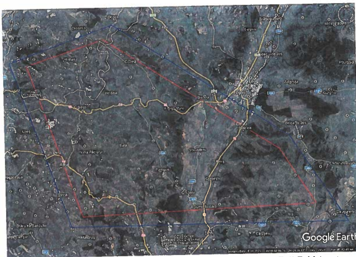
3D Transilvania NE- Perimetru achizitie (contur albastru) si Perimetru Full Fold (contur rosu)
